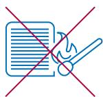
Не проверяйте тягу в дымовом и вентиляционном каналах с помощью огня.
