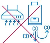
Не включайте вытяжку, когда работают газовый котёл или водонагреватель – угарный газ может попасть в помещение.
