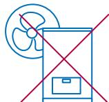
Не включайте вентилятор в ванной комнате, когда работают газовый котёл или водонагреватель.
