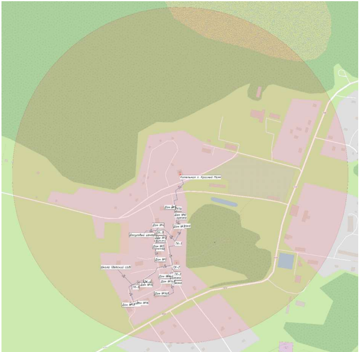
Рисунок 7. Радиус эффективного теплоснабжения котельной п. Мшинская
