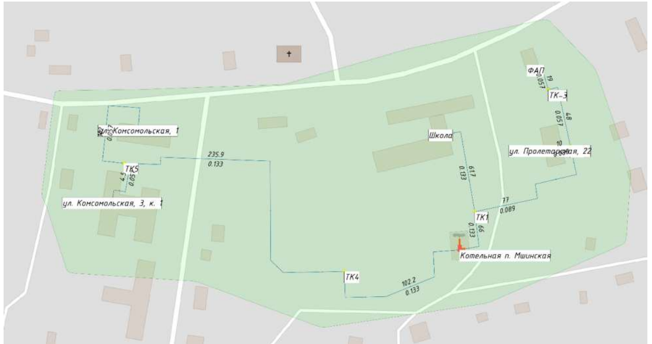
Рисунок 11. Зона действия котельной п. Мшинская
