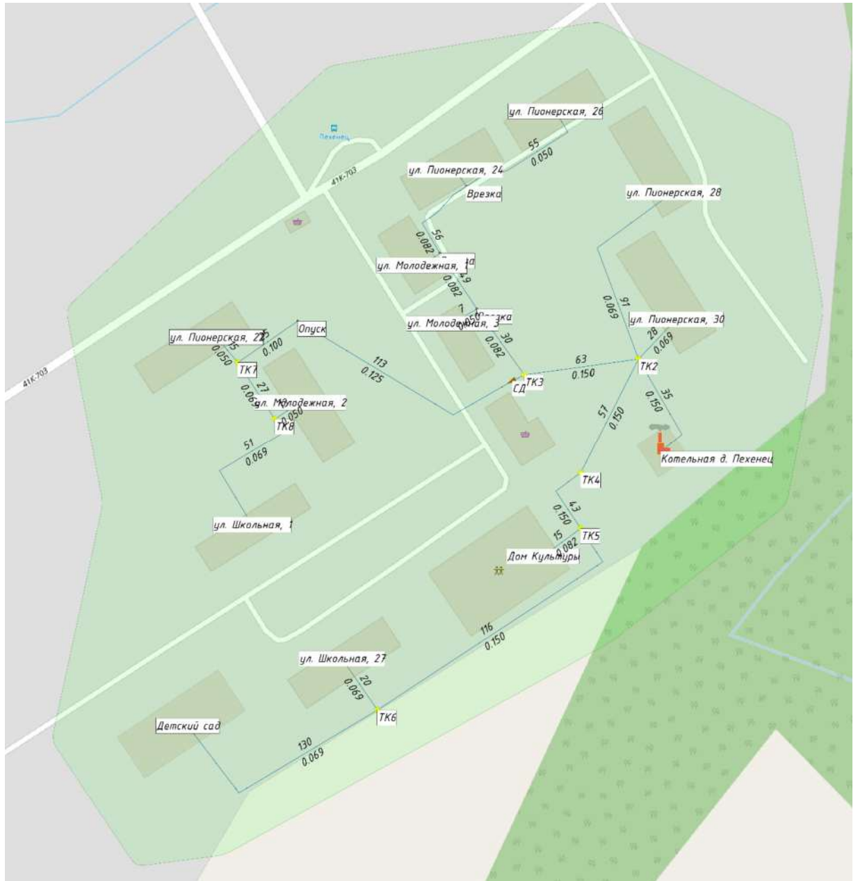
Рисунок 13. Зона действия котельной д. Пехенец
