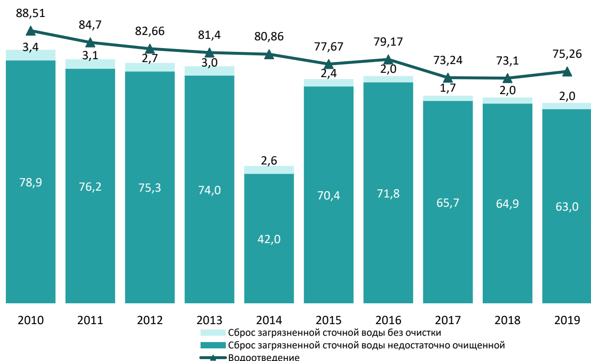
Рисунок 14.8.17 – Динамика водоотведения и сброса загрязненных сточных вод
