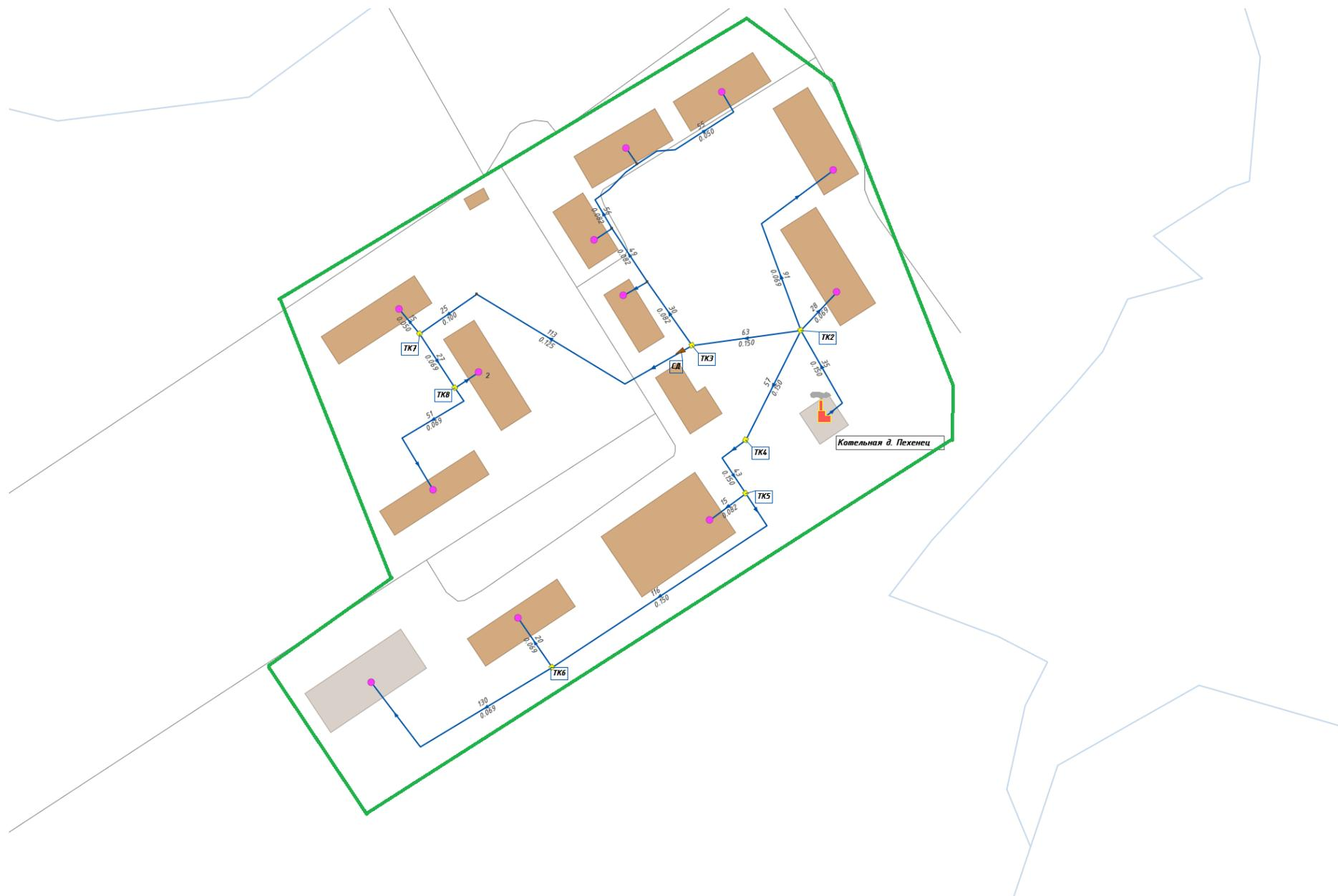
Рисунок 4. Зоны действия котельной д. Пехениц
